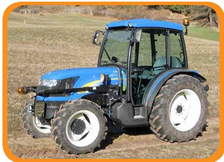
WICHTIG: Sollte der Abstand Radmitte - Kotflügeloberkante E= 67 cm sein, ist es nötig den Kotflügel bis E= 72 cm. zu erhöhen.
